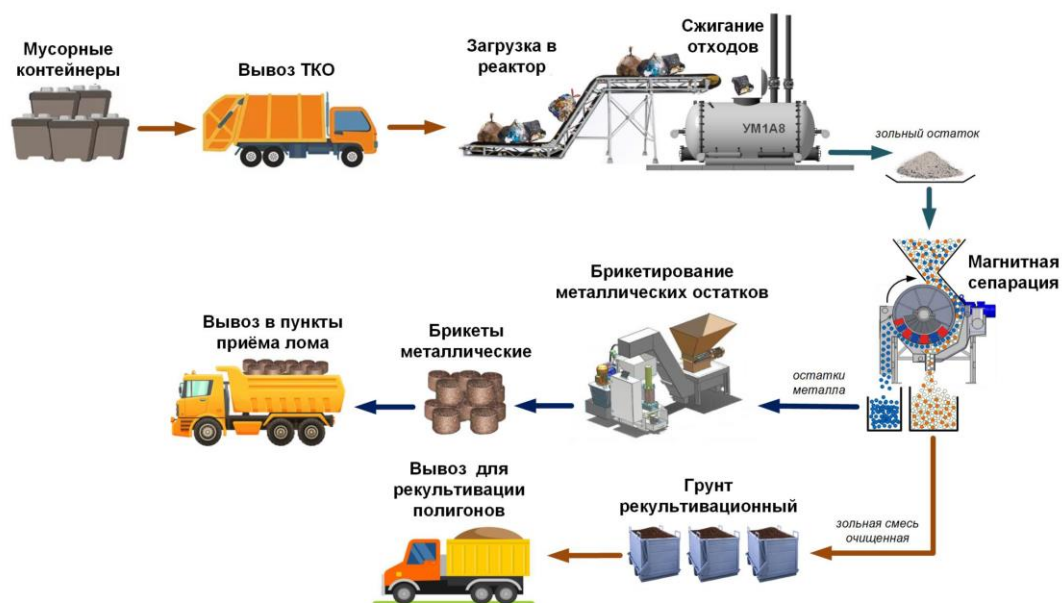
Рисунок 7 Обезвреживание отходов путем сжигания с использованием получаемого зольного остатка для восполнения дефицита рекультивационного грунта для полигонов
