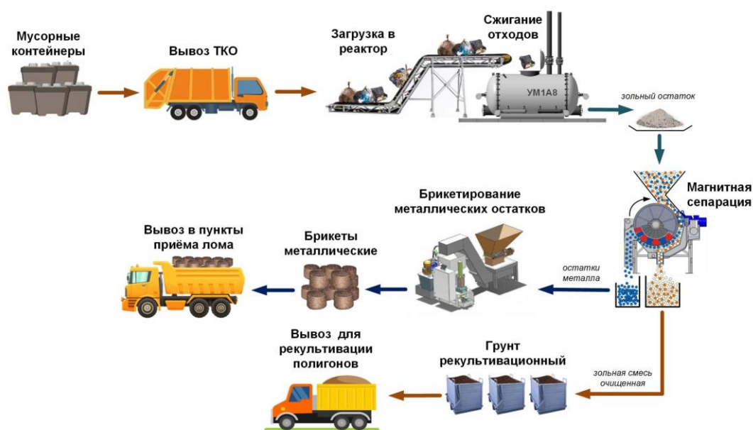
Рисунок 5.2 Утилизация отходов путём сжигания с последующей переработкой получаемого зольного остатка и производством вторичных материалов
